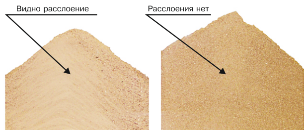
Премикс, произведенный по технологии простого смешивания Премикс, произведенный по технологии псевдокапсулирования
